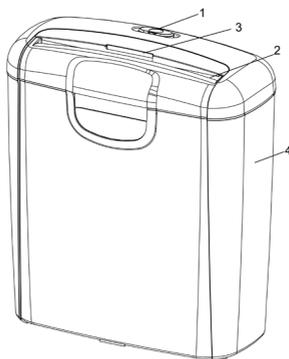
**1.** Schiebeschalter mit 3 Positionen mit den Funktionen AUTO, OFF und REV.
